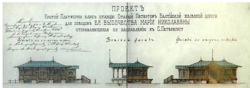
Илл. 33. Проект крытой железнодорожной платформы «Ее Высочества Марии Николаевны», конец 1860-х гг. (По Иванова, Мартирова, 2006).
